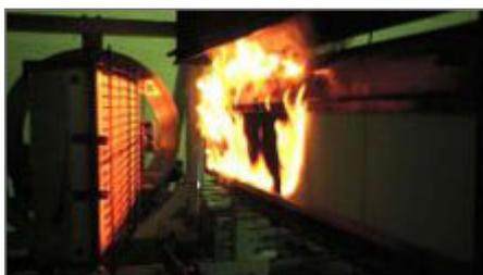
Funktionsprinzip: Die Proben werden in aufrechter Stellung gehalten und einer mit Gas betriebenen Strahlerplatte und einer Flamme ausgesetzt, die nicht in direkten Kontakt mit ihren Oberflächen kommt. Das heißeste Ende der Probe wird einem abstrahlenden Wärmefluss von 50,5 kW/m<sup>2</sup> ausgesetzt, der entlang des Reagenzglases abnimmt und schließlich am kältesten Ende eine Stärke von 1,2 kW/m<sup>2</sup> erreicht.
