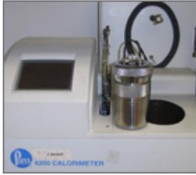
Bestimmung der Verbrennungswärme: NF EN ISO 1716
